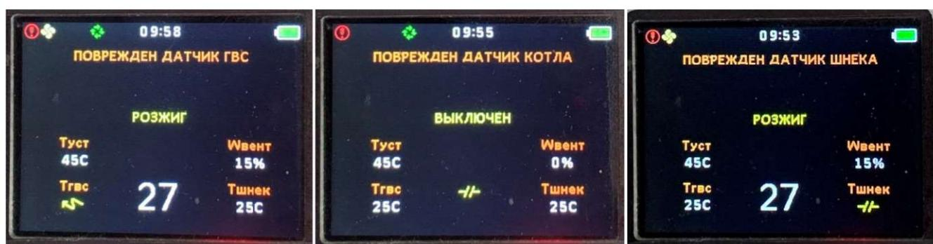
7.22.2 При неисправности датчика ГВС котел может работать, но насос ГВС при этом всегда включен при температуре выше 40 градусов. Насос ГВС можно отключить в КОНФИГРАЦИОННЫХ настройках.
