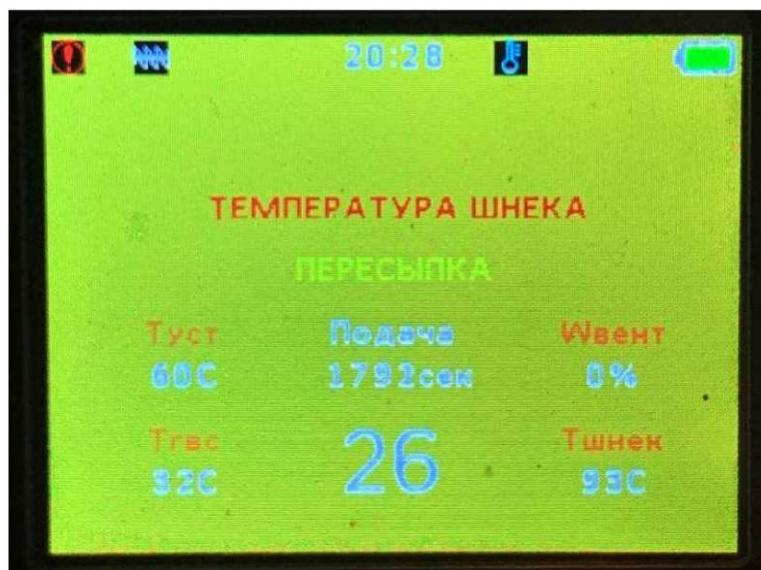
7.18.5 При работе котла на высокой температуре, шнек может нагреваться естественным образом так как шнек прикреплен к корпусу котла и может тепло нижней части котла передаваться на шнек. Поэтому не нужно ставить значение параметра ТЕМПЕРАТУРА ТРЕВОГИ ШНЕКА слишком низким, чтобы не было ложных срабатываний.
