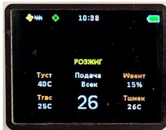
Рисунок 12 – Вид панели управления в режиме РОЗЖИГ
