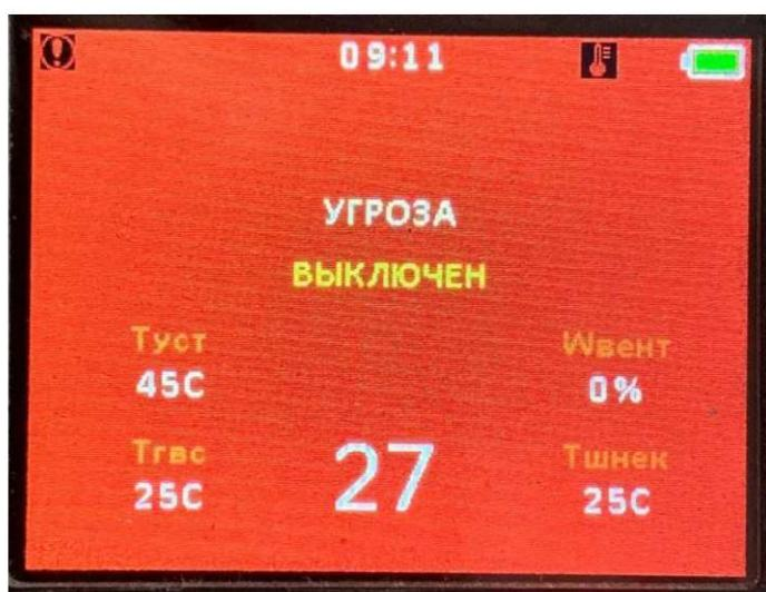
**ВНИМАНИЕ** - Шнек и вентилятор выключаются и включаются только при снижения температуры до 50°C после остывания датчика аварийного термостата.
